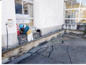
写真、珠洲市立飯田小学校での地震計の点検作業（2024年2月13日）。周囲には多くの被害が見られたが地震計は無事で、地震前後の観測記録を送り続けていた唯一の観測点である。
