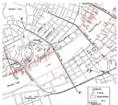
図-3 新潟市、信濃川にそった地盤側方流動 1) (部分)
