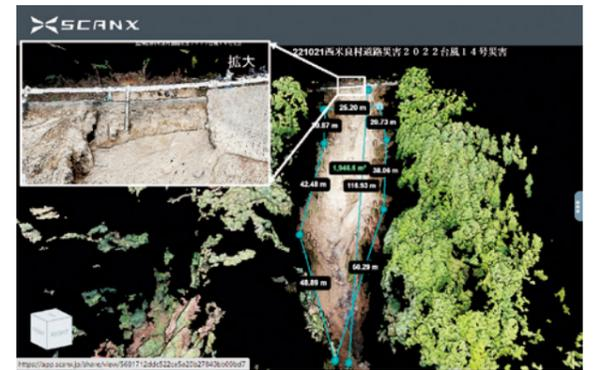
九州地方整備局 DX被災状況調査班 10月21日計測 民生品の安価なドローンで撮影した写真を解析し3Dモデルを構築。短時間(10分)で安全に計測が可能。クラウドで簡単に共有できる。
